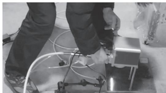
図5、コンクリート板高速除染2kWレーザーを用いて20m<sup>2</sup>/時間
